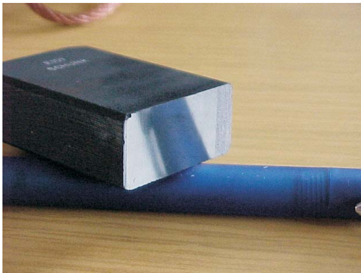
Εικόνα 2: Λεία επιφάνεια επαφής μπορεί να προκαλέσει θόρυβο της ψήκτρας
